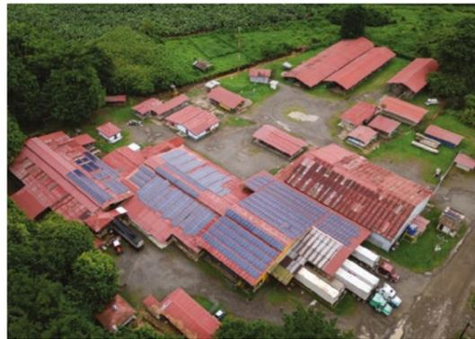
Como parte del proyecto Estrella Verde, instalamos paneles solares en las empacadoras de Valle La Estrella, Costa Rica. Buscamos reducir el consumo de energía convencional mediante la integración de fuentes renovables, optimizando así el desempeño energético de las instalaciones y **contribuyendo a la sostenibilidad ambiental**.
